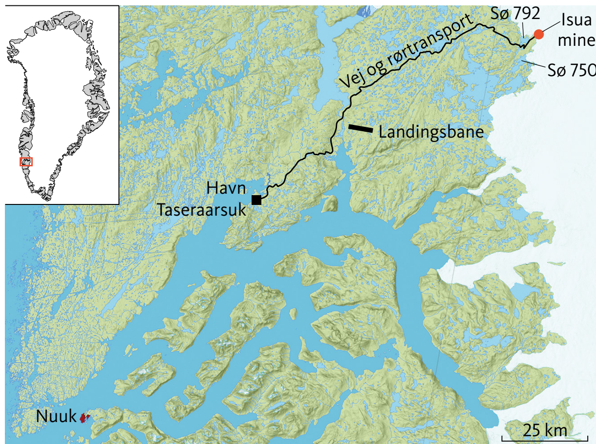
FIGUR 214. Infrastruktur for Isua-projektet. Mine og oparbejdningsanlæg ligger ved iskanten i ca. 1.000 m højde og ca. 100 km fra den havn, hvorfra man regner med, at jernmalmkoncentratet skal udskibes. Det kræver etablering af en lang vej, broer og et rørsystem til transport af malm fra minen til havnen. Efter Orbicon (2013).
